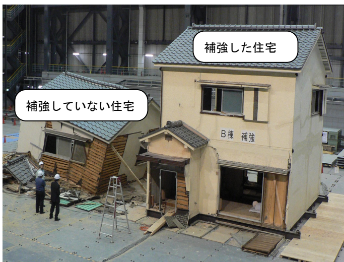
振動実験結果 出典：国立研究開発法人防災科学技術研究所
