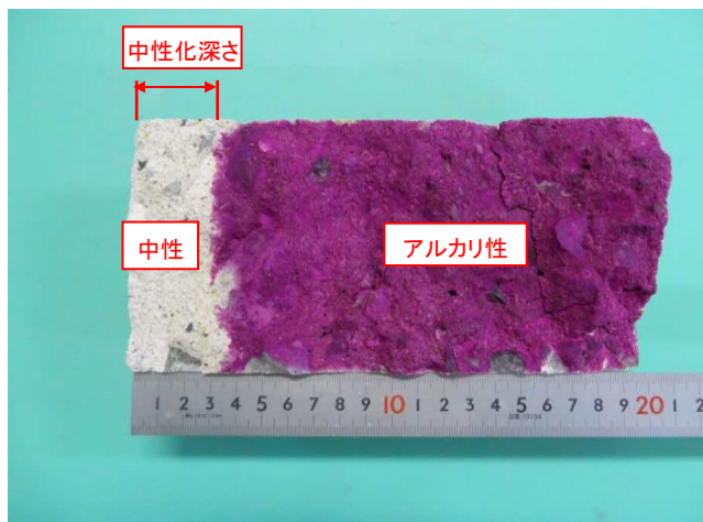
図 3-3 中性化深さの測定イメージ
