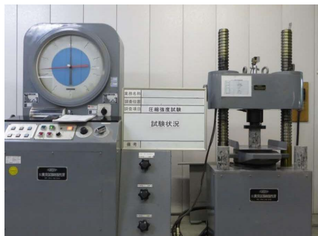
図 3-2 圧縮強度試験状況
