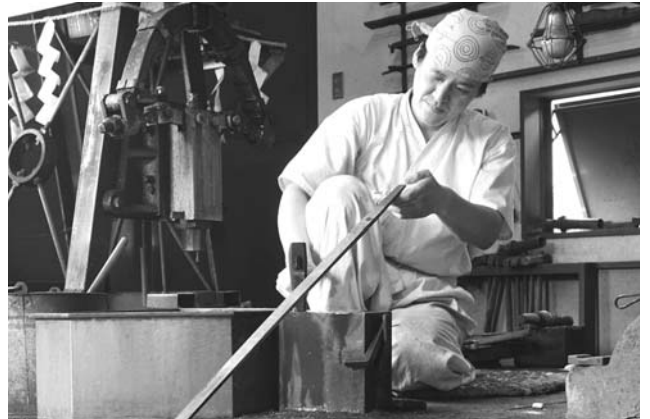
鍛刀場で鉄を打ち出し、刀の形を整える高見さん
