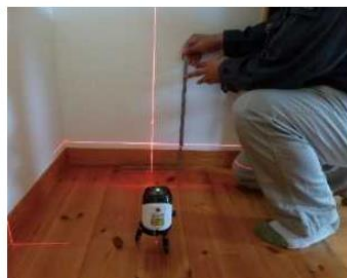
「床の傾きを計測する」調査機器
