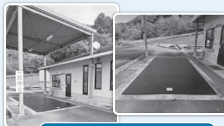
トラックスケール
