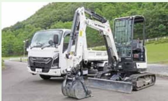
▲B&G財団から配備されたスライドダンプと油圧ショベル
